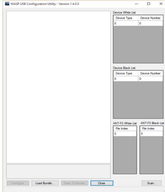
9. Branchez le WASP-N dans un port USB à l'aide d'un câble micro-USB. La zone à gauche se remplira avec les données pré-définies lues à partir du WASP-N.
