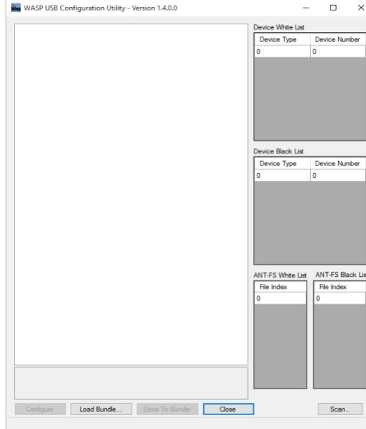
19. Schließen Sie den WASP-N mit einem Micro-USB-Kabel an einen USB-Anschluss an. Der Bereich links füllt sich mit den voreingestellten Daten, die aus dem WASP-N gelesen werden.
